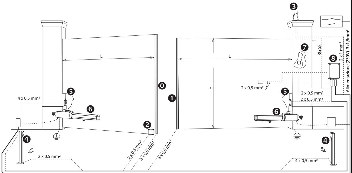
**COLLEGAMENTI ELETTRICI DEI SINGOLI COMPONENTI ESEGUITI CON LA CENTRALE DI COMANDO
