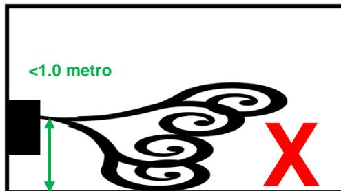
La posizione per il montaggio a parete ottimale è 2,5 metri dal pavimento di fronte alla zona da proteggere e utilizzando un ugello angolo appropriato . Il montaggio - altezza massima sopra il livello del pavimento è di 3 metri , la minima è di 1 metro e non ci dovrebbero essere ostacoli entro 1 metro dall'ugello per l'uscita di fumo.
